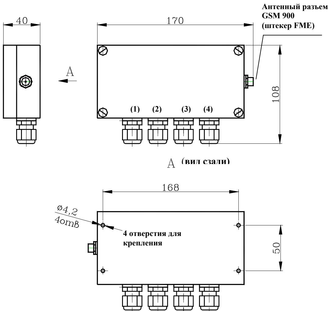
**Кабельный ввод (1) – подключение дискретных входов D8..D15**
