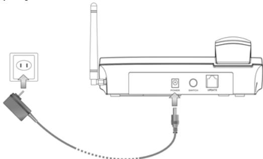
3.2.6. Нажмите кнопку включения телефона (на обратной стороне базового блока) и при необходимости введите PIN-код SIM-карты. Дождитесь загрузки телефона и регистрации его в сети сотовой связи.
