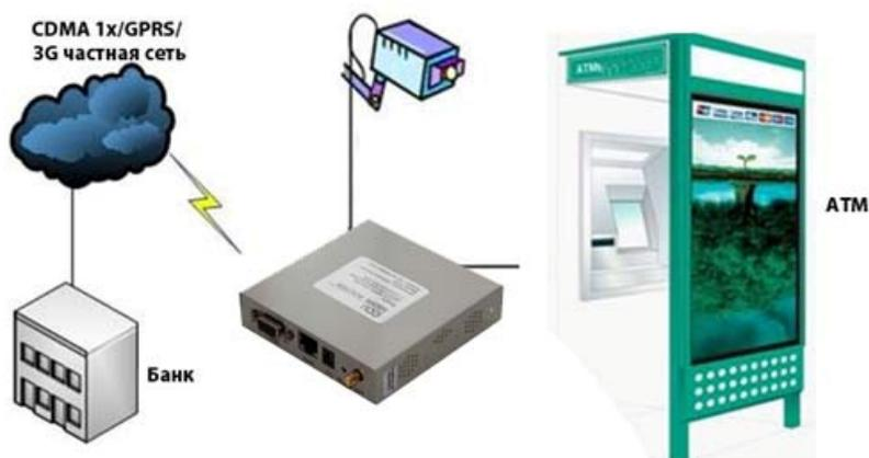
Схема 2.3-3: Схема подключений для применения в банковских операциях
