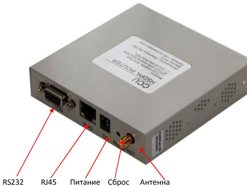
Рис. 2.1.1-2 Задняя панель
